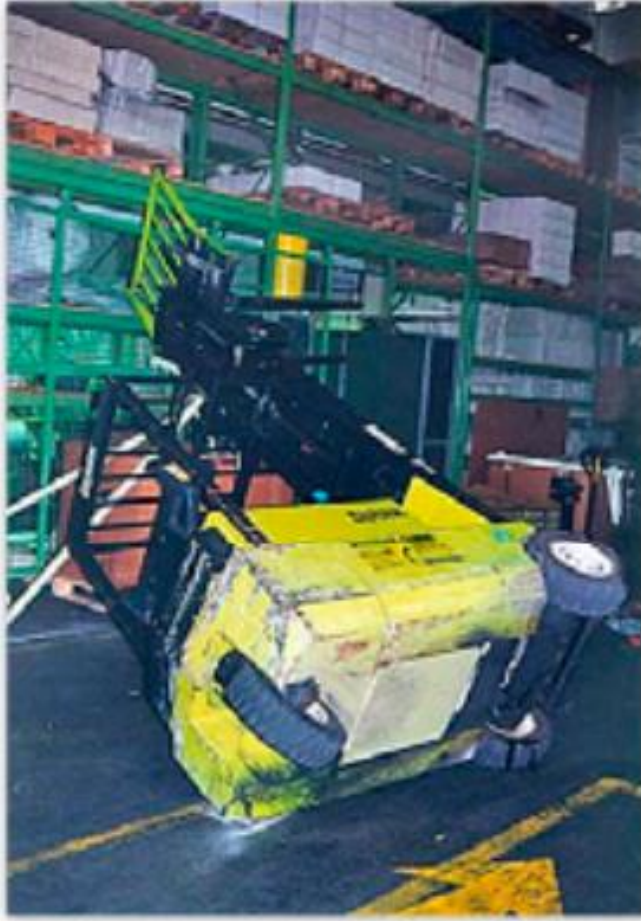
Fahrt mit angehobener Last, Stapler kippt in das Regal.
