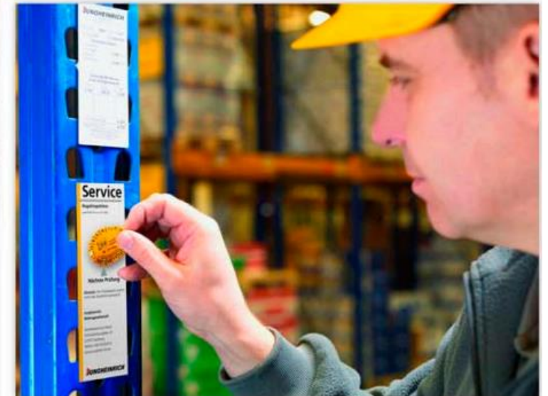
Prüfplakette mit Hinweis auf den nächsten Inspektionstermin
