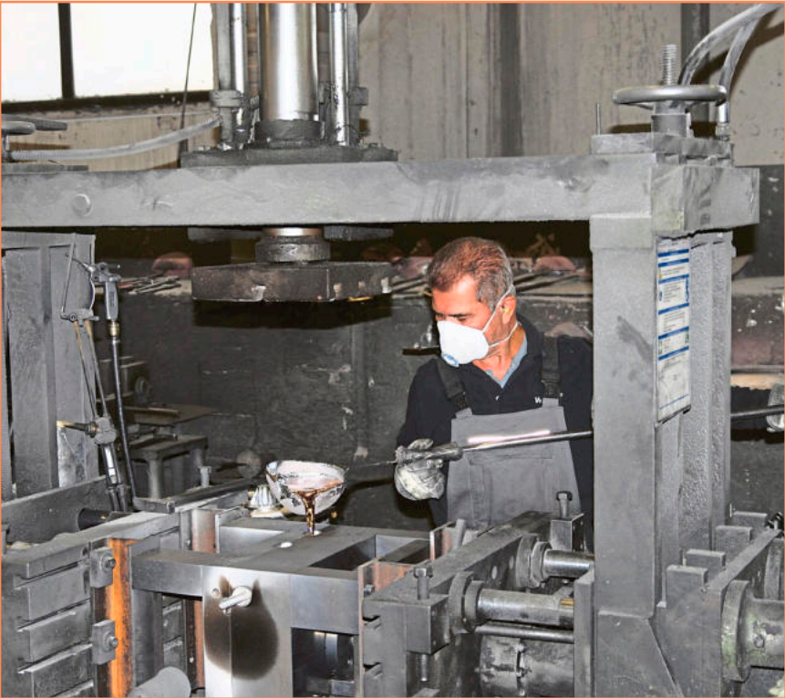
In der Gießerei wird Roh-Aluminium geschmolzen und zu Elementen gegossen. Hier gießt Mitarbeiter Bilal flüssiges Aluminium in entsprechende Formen.
